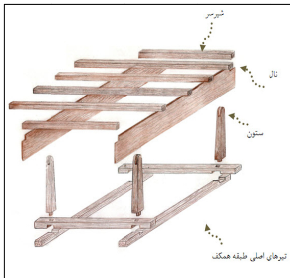
تصویر ۴. نحوه اتصالات طبقه اول (ترسیم: نگارنده).
